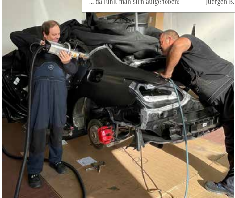
Trockeneisstrahlen zur Unterbodenkonservierung.
