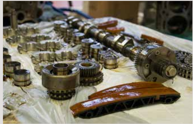
Die Einzelteile eines AMG V8 Motors – Ablage nach System.
