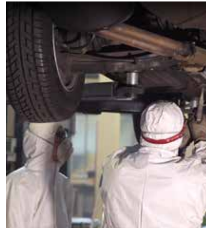
Trockeneisstrahlen zur Unterbodenkonservierung.
